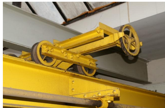
Foto 4, Detail Kat Ketelhuiskraan
