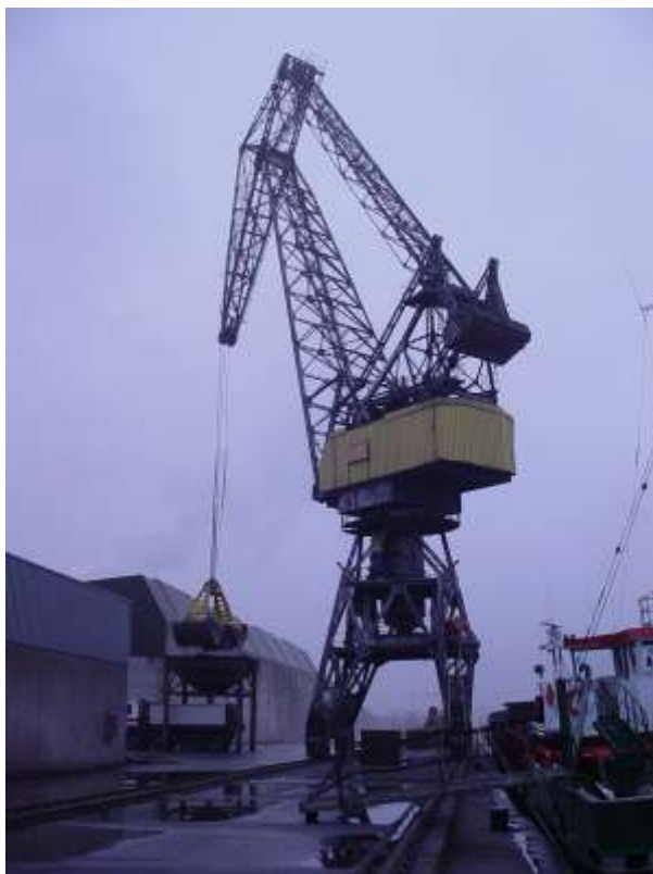
Ander type van Kampnagel, een Tuimelarmkraan bij Marcor in de Waalhaven Rotterdam.
