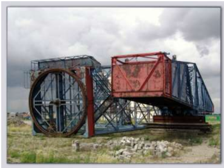
De gedemonteerde kraan, links de zwenkrand bovenop de toren met in het midden de spil.
