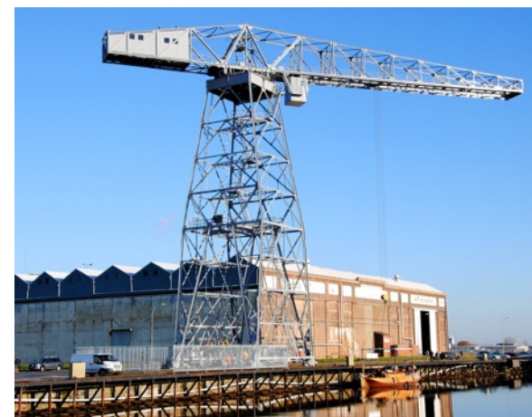
Torendraaikraan van De Schelde in Vlissingen bij zijn eerste hijsklus na restauratie
