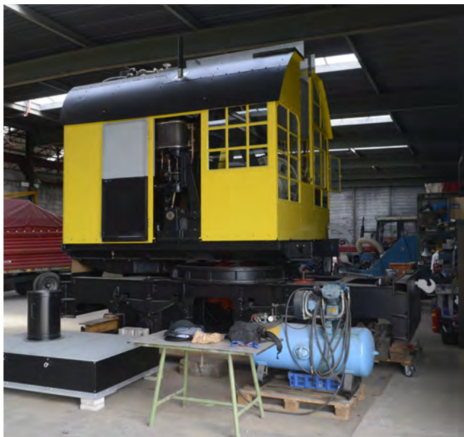
Het machinehuis met onderwagen van Stoomhijskraan Schelde 38 is klaar om samengevoegd te worden met de wielassen en hijsarm. Foto: Geert de Weger, 8-7-2021.
