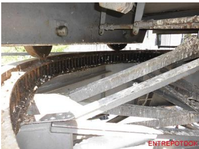
Detail zwenkrand met rail, zwenkwielen en pennenbaan. (Foto: Figeo)
