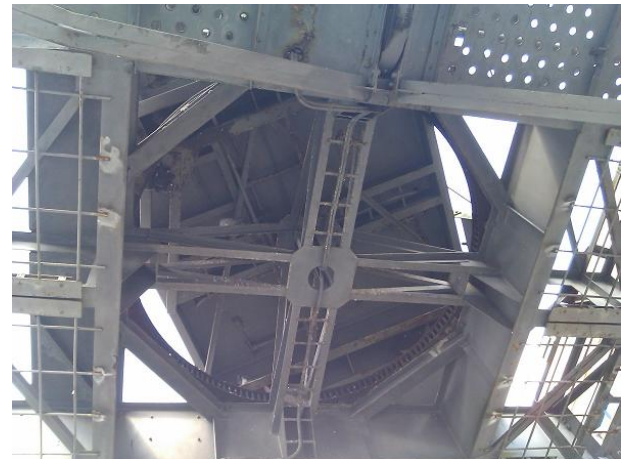
Kraanportaal en onderkant zwenkrand met Koningsspil. (Foto's: GJ)
