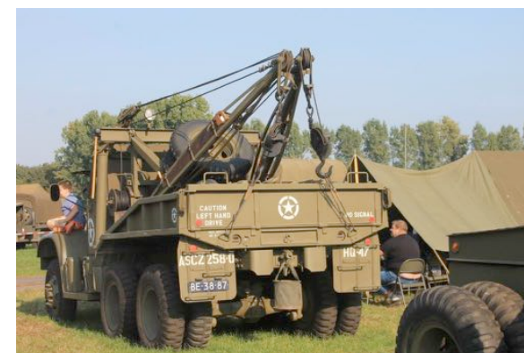
Ward-LaFrance detail frame met giek toppend en zwenkend (Foto Jur Kingma)
